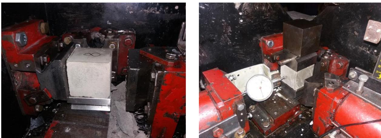
Рисунок 2.3 – Общий вид установки УНТН для испытаний кубиков на сжатие
