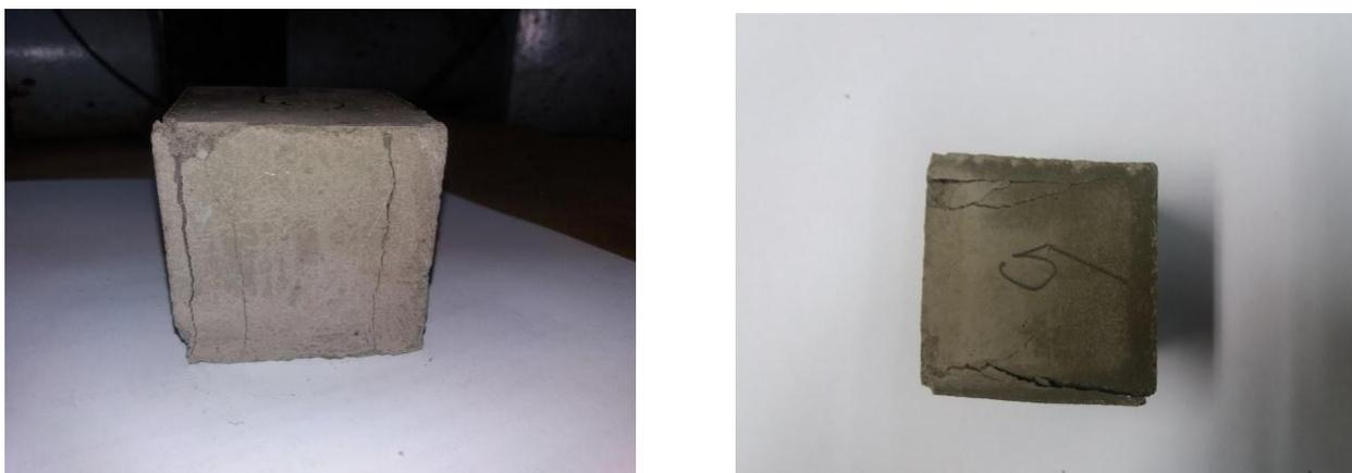
Рисунок 2.4 – Разрушение образца при испытании на сжатие
