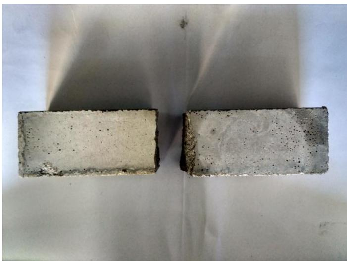
Рисунок 2.5 – Общий вид образца после испытания на растяжение (при изгибе)
