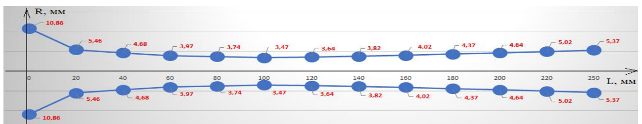
Рисунок 2.24 – Сопло устройства пожаротушения длиной 250 мм
