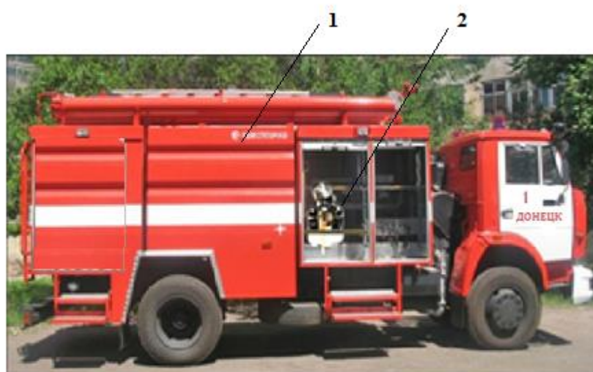
1 – пожарный автомобиль; 2 – установка пожаротушения.
