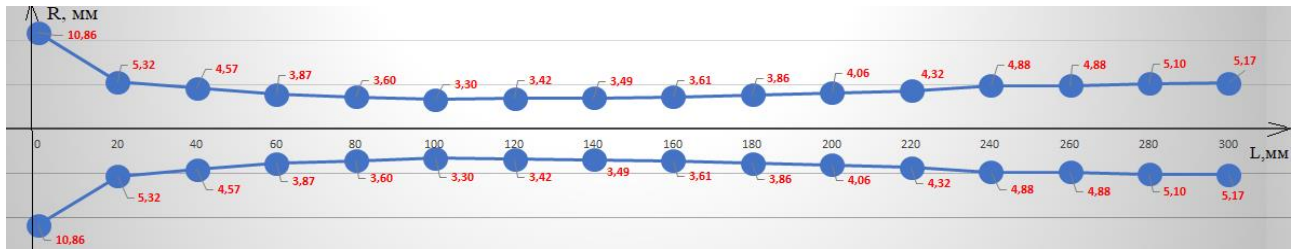
Рисунок 2.25 – Сопло устройства пожаротушения длиной 300мм
