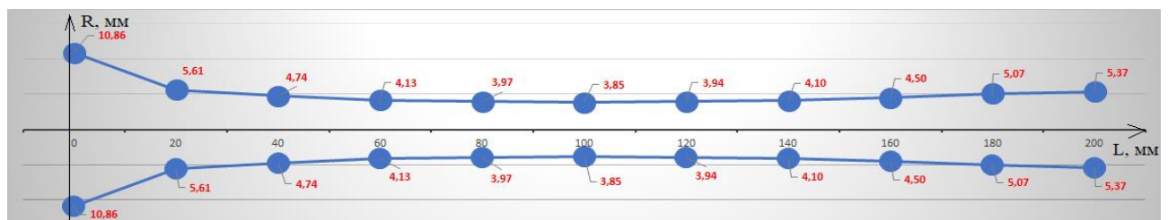
Рисунок 2.23 – Сопло устройства пожаротушения длиной 200 мм
