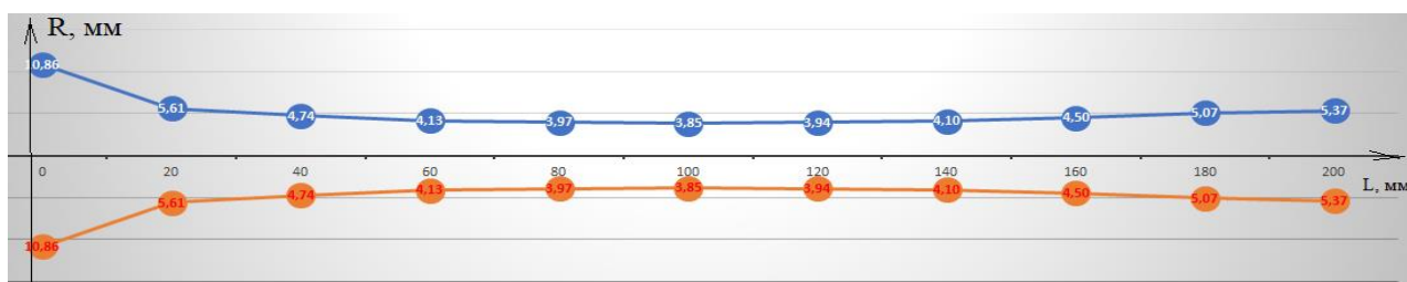
Рисунок 10 – Геометрический профиль сопла
