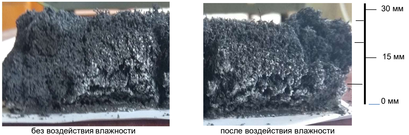
Рисунок 4.10 – Вспучивание огнезащитного покрытия
