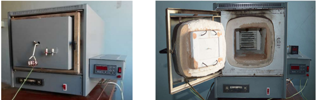
Рисунок 2.2 – Лабораторная установка для исследования и оценки теплоизолирующих и огнезащитных свойств огнезащитного вспучивающегося покрытия для металлических конструкций
