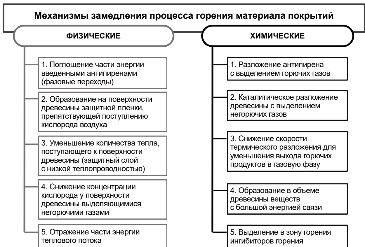
Рисунок 3.1 – Механизмы замедления процесса горения материала покрытий для огнезащиты древесины
