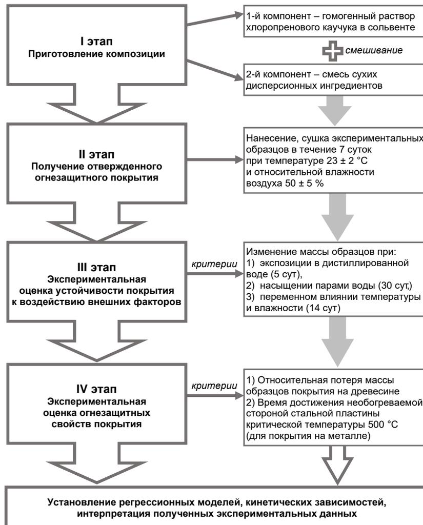
Рис. 2. Блок-схема алгоритма экспериментальных исследований
