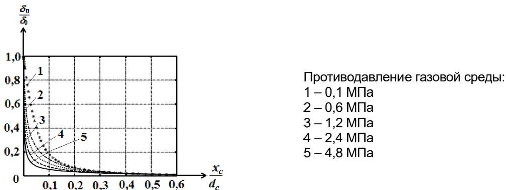
Рис. 2. Зависимость относительной толщины пленки жидкости в спутном потоке газа от относительного расстояния до среза сопла центробежной форсунки при различном противодействии газовой среды
