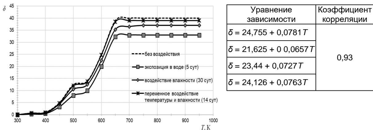
Рис. 3. Результаты исследований изменения кратности вспучивания от температуры нагрева огнезащитного покрытия
