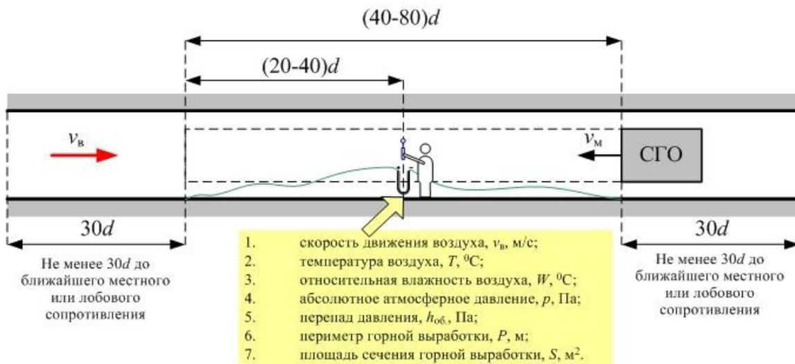
Рис. 3. Схема проведения измерений при встречном движении самоходного горного оборудования и воздушного потока ( $d$  – гидравлический диаметр, м,  $d = 4S/P$ )
