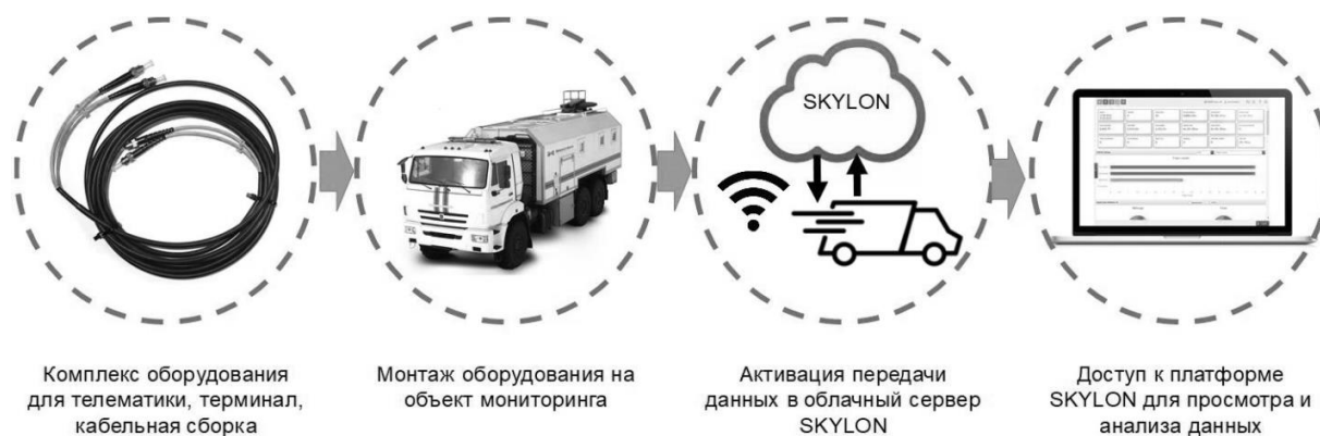
Рис. 1. Визуальное отображение алгоритма внедрения системы телеметрии
