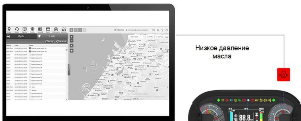
Рис. 2. Визуальное отображение возникающих оповещений по показателям датчиков АСМТК
