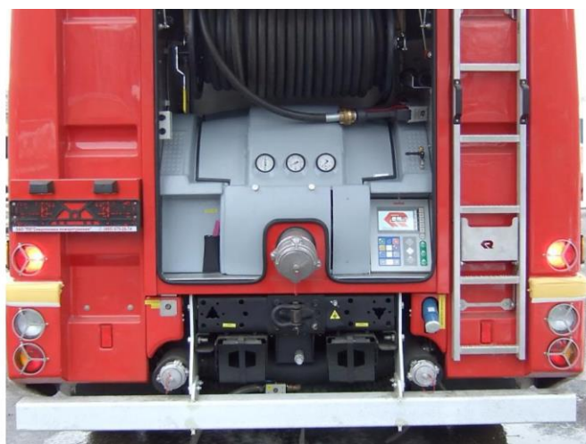
Рис. 3. Насосный отсек пожарной автоцистерны АЦ-3,2-40/4(43253) 2 : управление насосной установкой при помощи пульта с дисплеем
