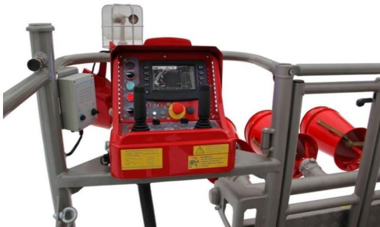
Рис. 4. Пульт управления в люльке пожарного коленчатого подъемника с лестницей АПК-32
