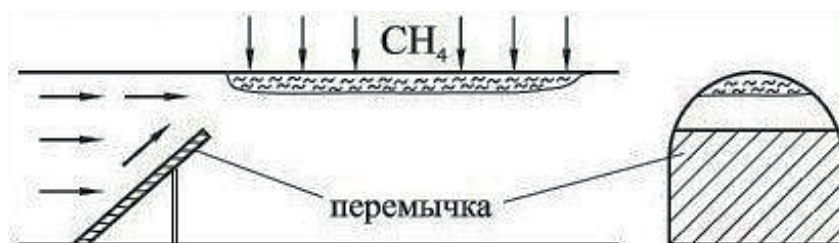
Рис. 7. Схема монтажа перемычки в нижней части выработки
