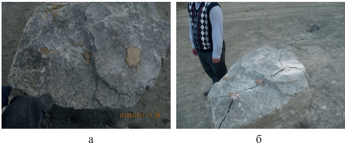
Рис. 1. Общий вид гранитного блока с расстоянием между шпурами 0,3 м: а – до разрушения; б – после разрушения
