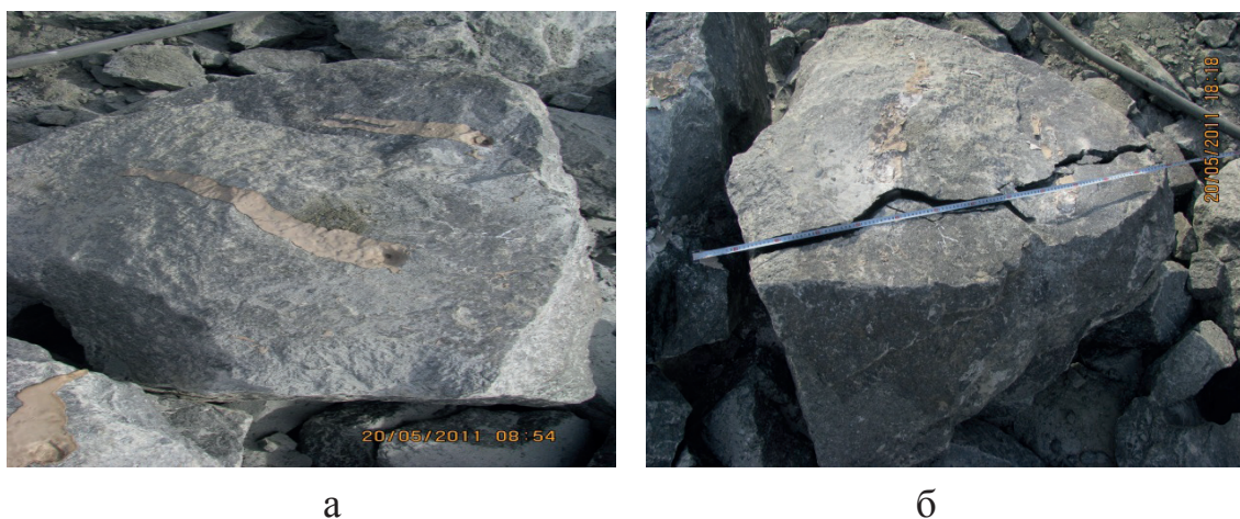
Рис. 2. Общий вид гранитного блока с расстоянием между шпурами 0,5 м: а – до разрушения; б – после разрушения
