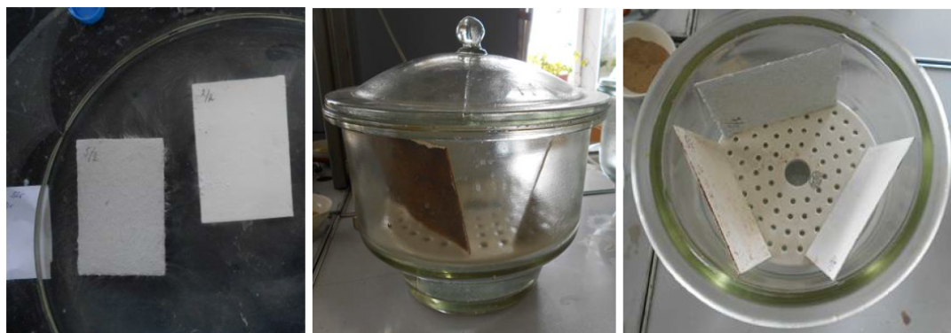
Рис. 1. Испытания огнезащитных покрытий по воздействию на них эксплуатационных факторов: а – вода (3 сут); б – влажность (30 сут)
