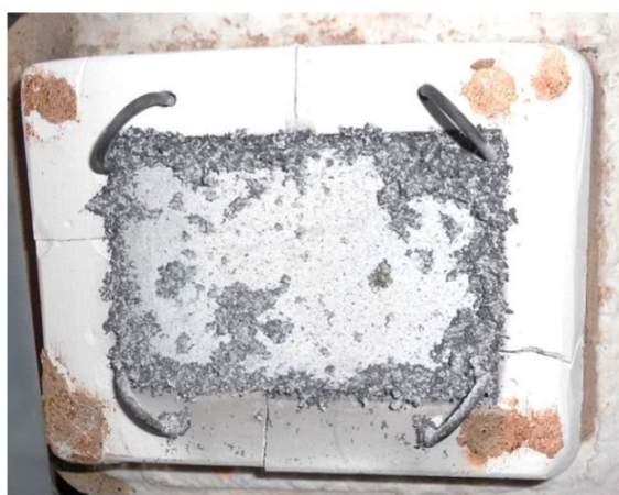
Рис. 3. Внешний вид покрытия после воздействия воды и испытаний на лабораторной установке
