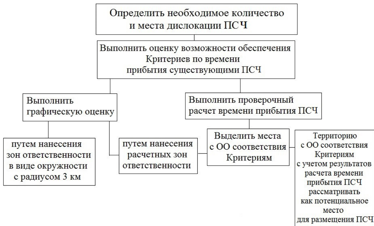
Рис. 1. Алгоритм определения необходимого количества пожарно-спасательных подразделений и мест их дислокации:
