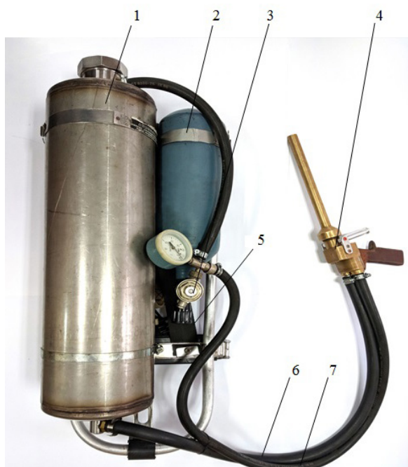
Рис. 3. Общий вид экспериментального образца установки пожаротушения: 1 – бак для хранения воды; 2 – баллон со сжатым воздухом; 3 – газовый редуктор давления; 4 – устройство пожаротушения; 5 – манометр; 6 – шланг подачи воды; 7 – шланг подачи воздуха
