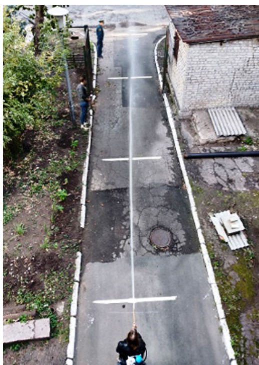
Рис. 5. Проведение исследований на дальность подачи газокпельного потока
