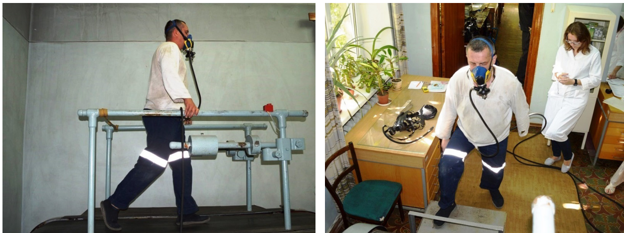
Рис. 5. Приёмочные испытания малогабаритного шлангового дыхательного аппарата с участием испытателей-добровольцев
