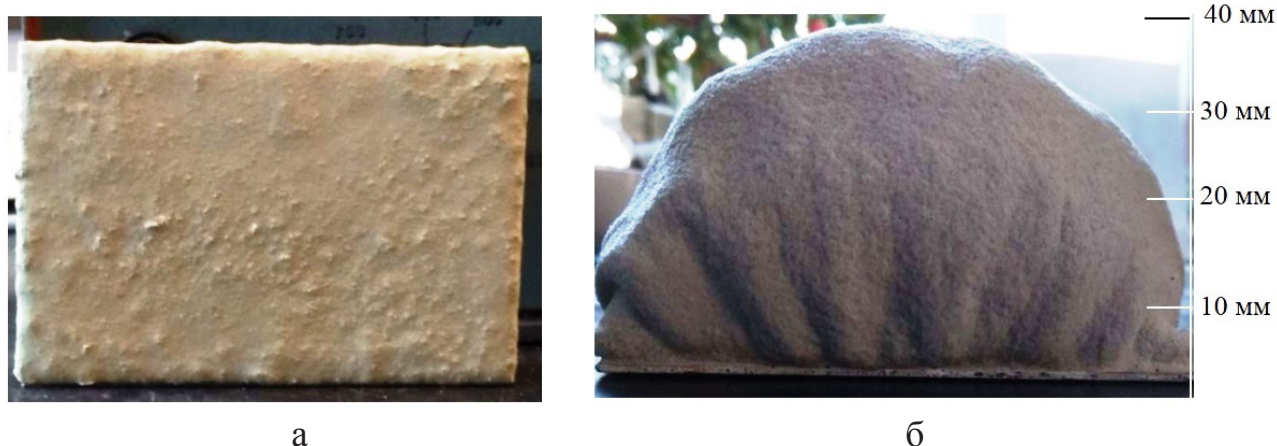
Рис. 3. Огнезащитное покрытие на стальной пластине до и после термического воздействия в муфельной печи:
