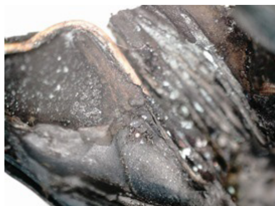
Рис. 2. Карбонизация изоляционного материала с внутренней стороны при увеличении в 300 раз
