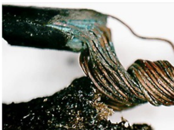
Рис. 1. Оплавления на поверхности изоляции проводов при увеличении в 200 раз
