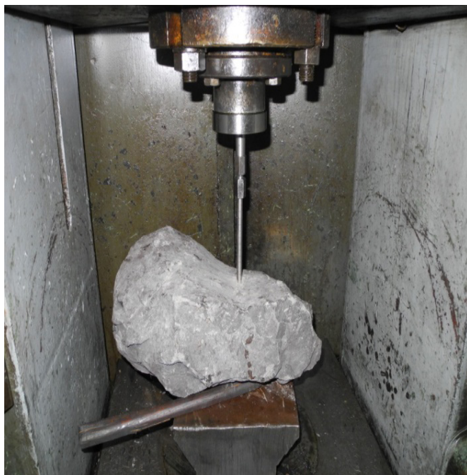
Рис. 2. Запрессовка анкера в образцы глинистого сланца
