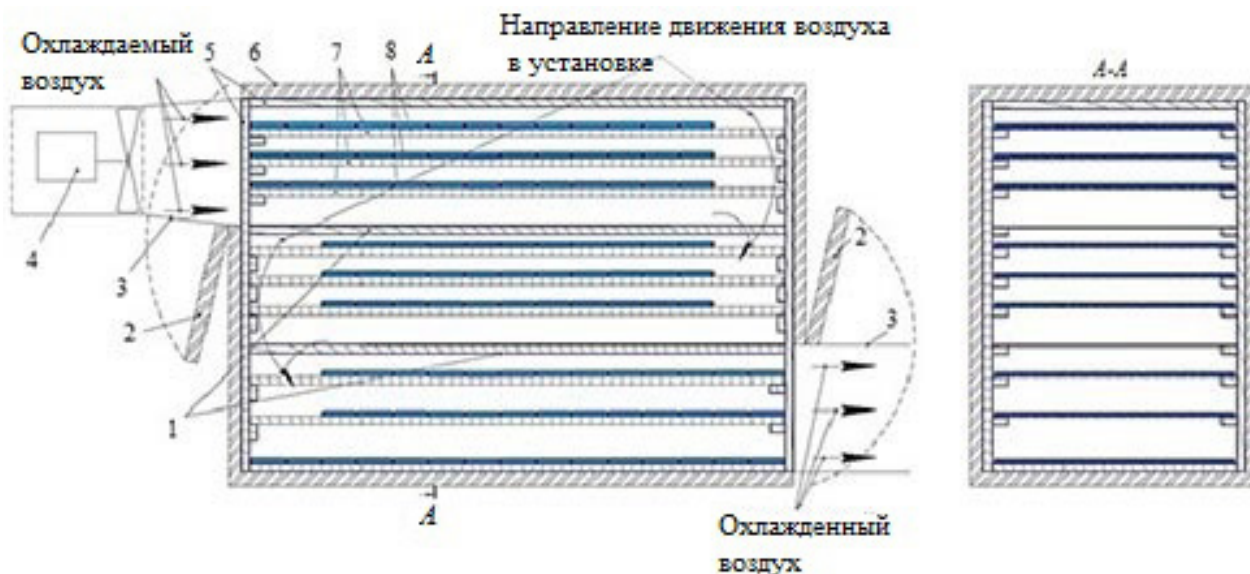
Рис. 1. Общий вид установки для локального охлаждения воздуха в горных выработках глубоких шахт:
