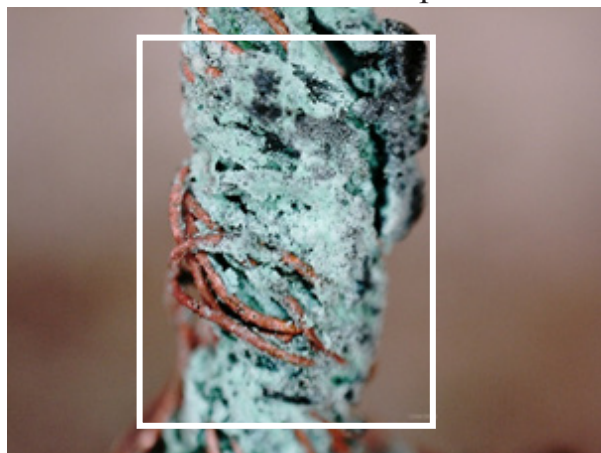
Рис. 8. Образование оксидной пленки на поверхности жил медных проводов в месте контактного соединения «в скрутку» при увеличении в 350 раз
