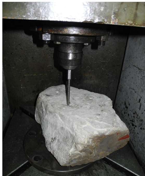
Рис. 3. Запрессовка анкера в образцы песчаника
