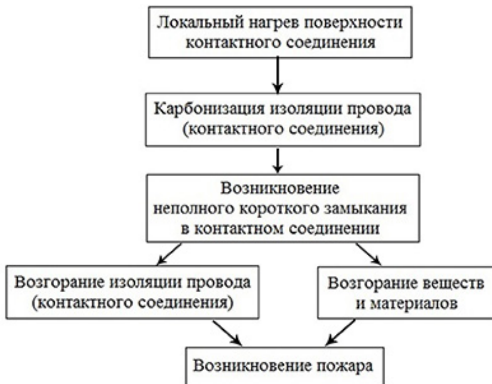
Рис. 1. Схема возникновения пожара при локальном нагреве поверхности контактного соединения
