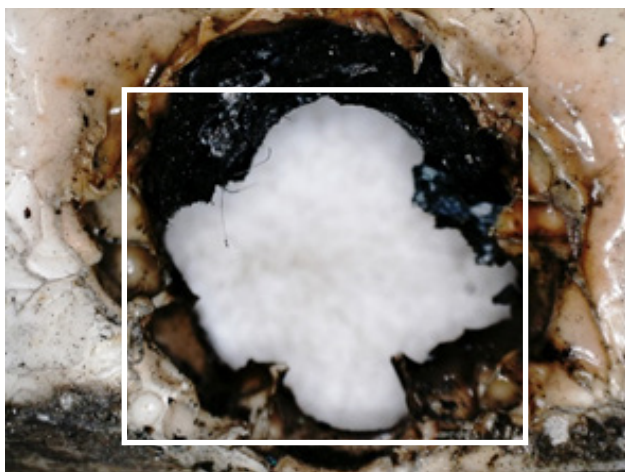
Рис. 2. Локальное оплавление поверхности полимерного материала корпуса электророзетки при увеличении в 350 раз
