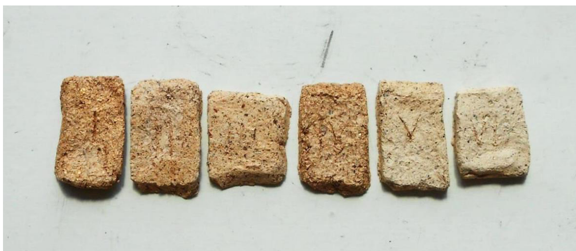
Рис. 2. Образцы термостойких составов после испытаний
