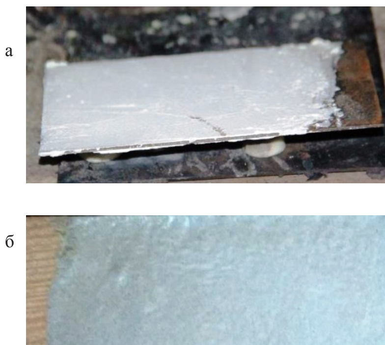
Рис. 1. Внешний вид полимерной композиции до термического воздействия: а – на металле; б – на древесине
