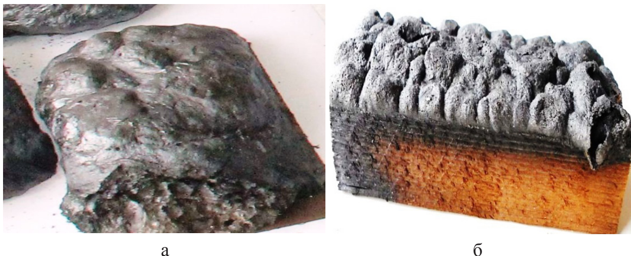
Рис. 2. Защитный слой полимерной композиции после термического воздействия: а – на металле; б – на древесине
