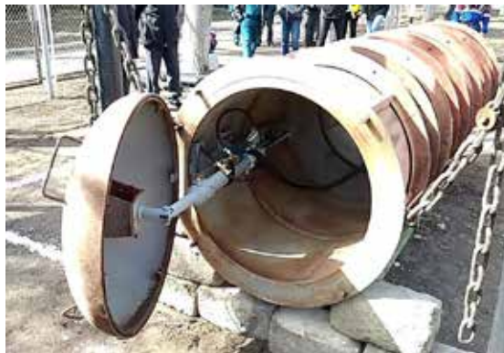
Рис. 3. Крепление пневмоцилиндра рабочего устройства на головной секции комплекта проемной трубы
