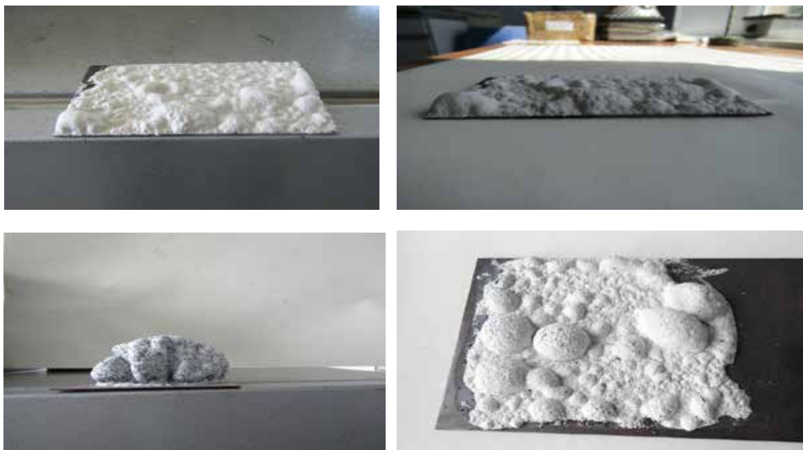
Рис. 1. Силикатные покрытия на металле после термического воздействия
