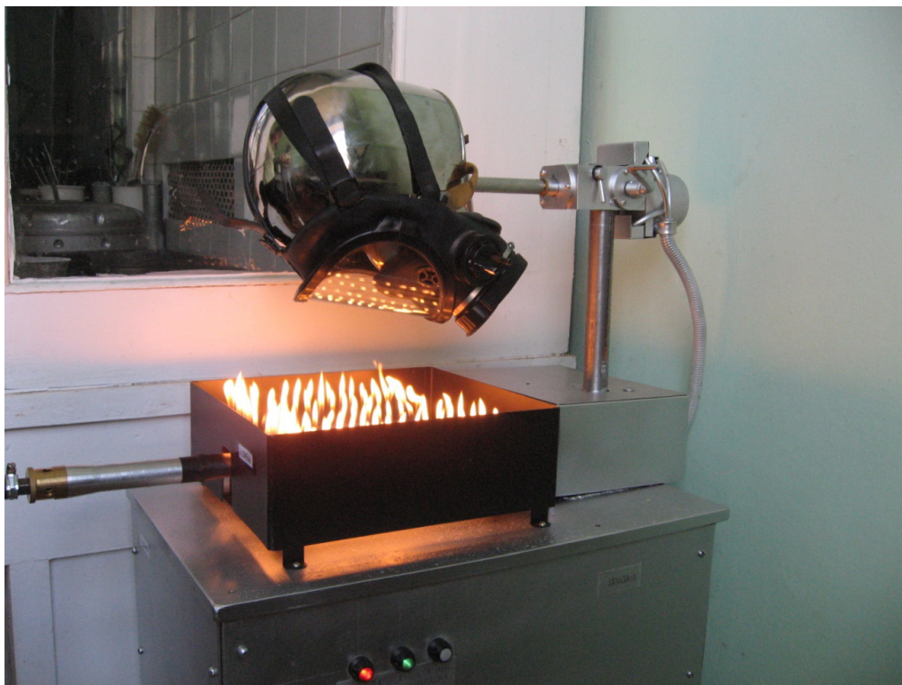
Рис. 5. Установка для определения огнестойкости самоспасателя
