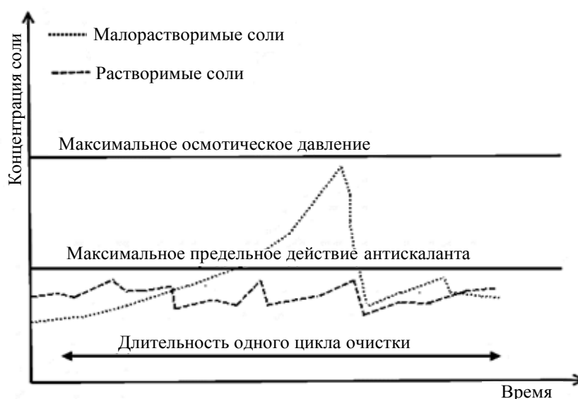
Рис. 3. Поведение растворимых и труднорастворимых солей во время рабочего цикла
