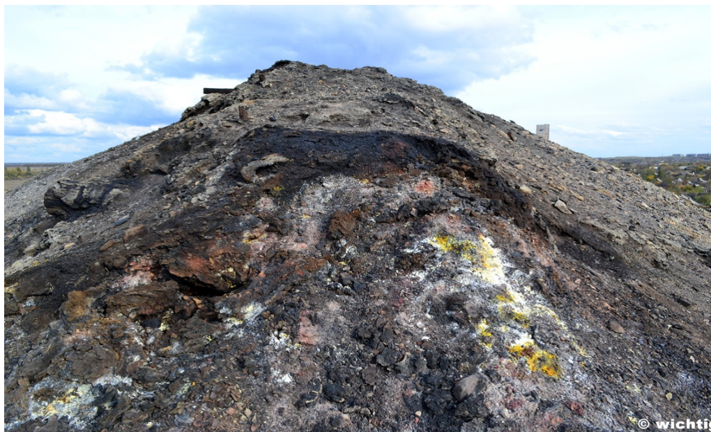
Рис. 1. Очаги горения на породном отвале
