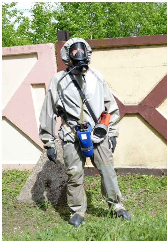
Рис. 3. Дыхательный аппарат АДВП при проведении натурных испытаний:
