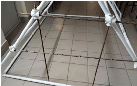
Рис. 1. Модуль заграждения из арматуры
